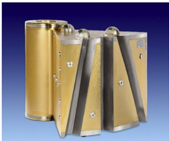
图 10 PTB 的扇形大齿轮样板 [34]
