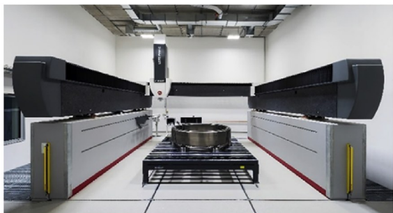
图 17 PTB 的 CMM ( 5 \text{ m} \times 4 \text{ m} \times 2 \text{ m} ) [35]
