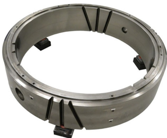
图 11 PTB 的大齿圈标准样板 [36]
